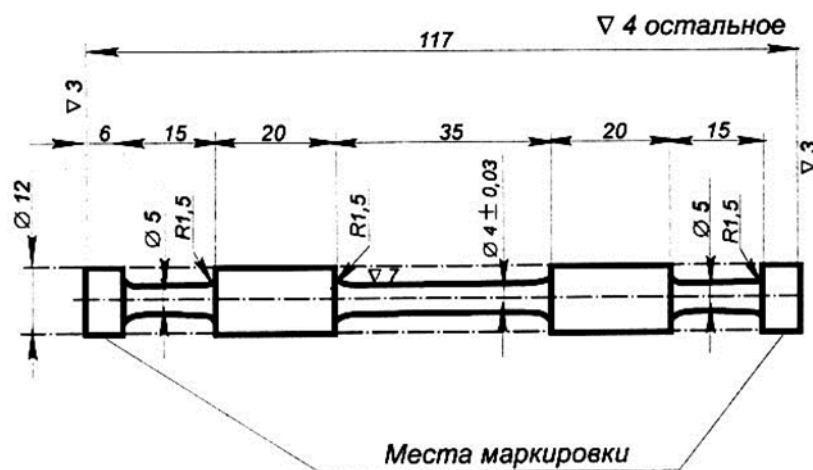
Рисунок 2.4.9.3 — Образец для испытаний на медленное растяжение
