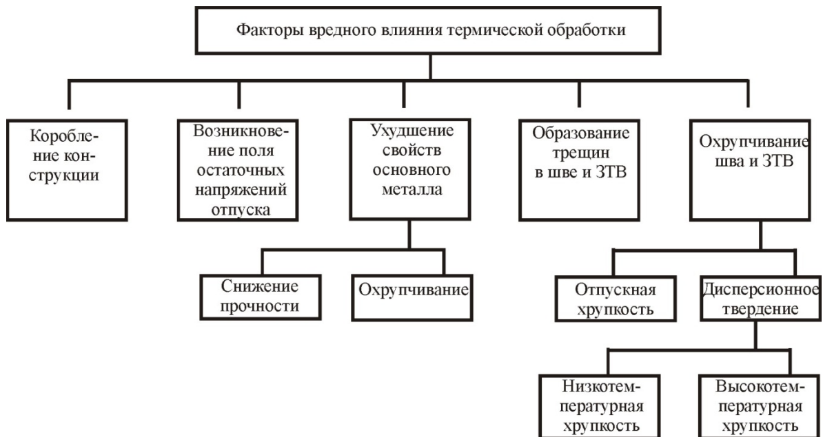
Рисунок 1.2.3.1 – Возможные отрицательные последствия проведения термической обработки [62].
